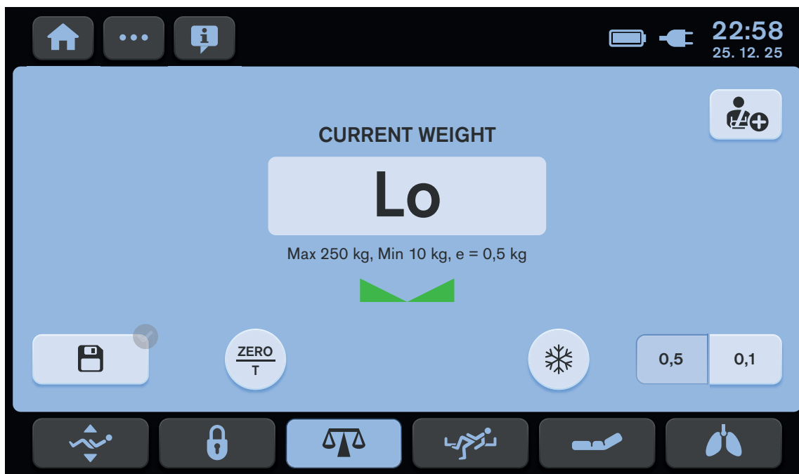
Fig. Underbelastet seng (vist med Lo)
