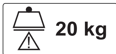
Fig. Sikker arbejdsbelastning for remskiven
